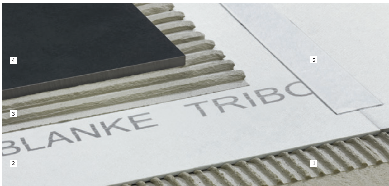
1 Flexklebermörtel 2 BLANKE TRIBOARD 3 Flexklebermörtel 4 Oberbelag 5 BLANKE TRIBOARD SK-Stoßvliesband
