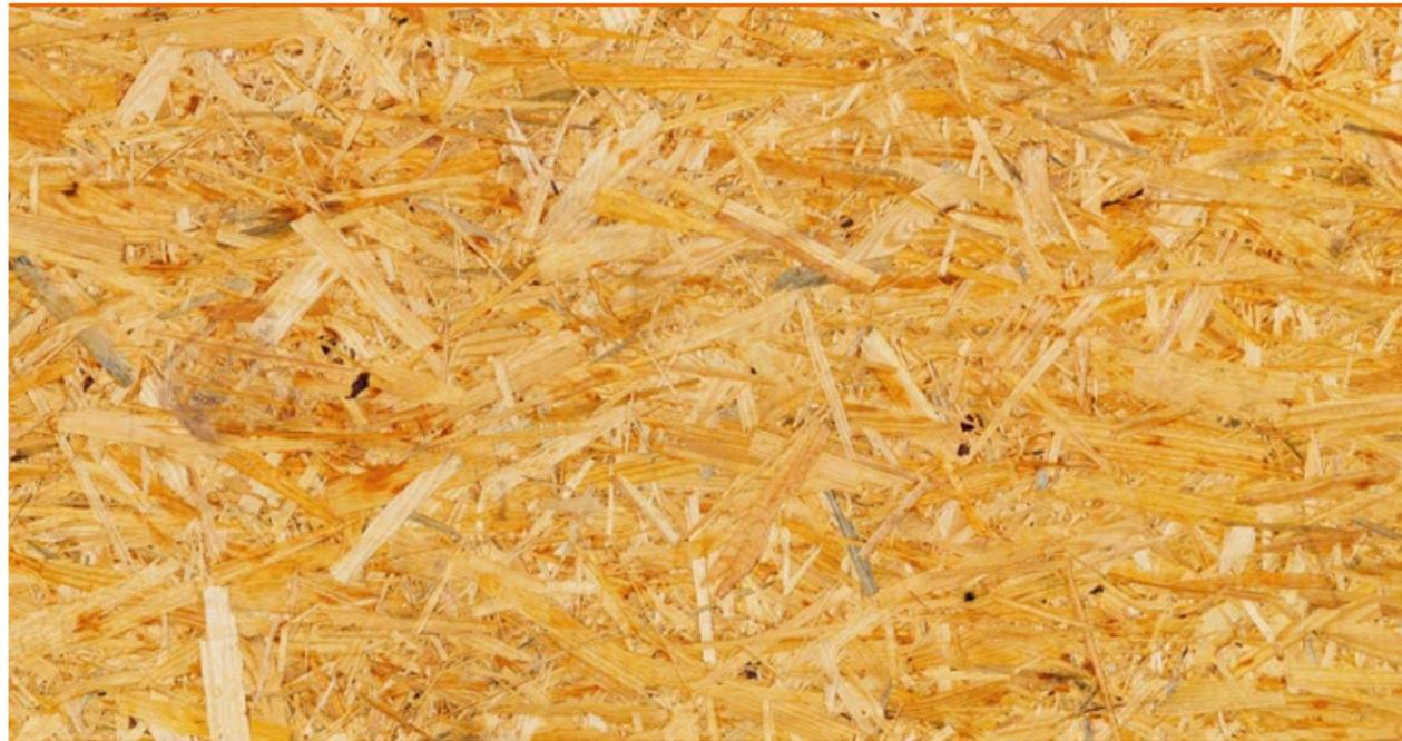
Holz ist ein „lebender“ Baustoff, der sich bei Feuchtigkeitsaufnahme und Wasserdampfeinwirkung verformt (Quellen und Schwinden). Im Gegensatz dazu bleibt ein keramischer Fliesenbelag formstabil. Bei geeigneter Vorbereitung (Dampfsperren und Abdichtungen) lassen sich auch Untergründe aus Holz- und Spanplatten an Wänden im Innenbereich sicher mit Fliesen und Platten belegen. Am Boden ist jedoch häufig zuvor eine Stabilisierung mit der nachfolgend beschriebenen Methode erforderlich.
