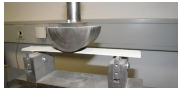
stark verformbare Flexkleber mit einer Durchbiegung von mindestens 5 mm beschreibt, was doppelt so hoch ist wie bei der deutschen Richtlinie „Flexmörtel“.
