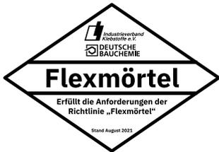
Produkte, die mit der **Flexmörtel-Richtlinie** (auch Flexmörtel-Raute genannt) gekennzeichnet sind, werden als flexibel bezeichnet, wenn sie die C-2-Kriterien der DIN EN 12004 erfüllen. Das heißt, sie erreichen bei allen Lagerungsarten eine Haftfestigkeit von  $\geq 1,0$  N/mm<sup>2</sup> und nach DIN EN 12002 wird eine Verformung  $\geq 2,5$  mm gemessen.
