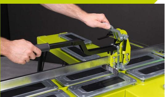
Kugelgelagerter Schneidkopf mit Gasdruckdämpfer ermöglicht einen gleichmäßigen Druck des Schneirades
