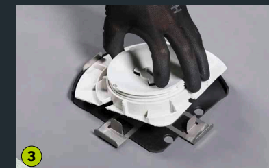
3 BL Tower: stabiles Kunststoffstelzlager in 5 versch. Höhen: 21-30 mm, 29-40 mm, 43-72 mm, 70-126 mm und 124-234 mm, inkl. Aufnahmeteller
