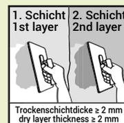
Abdichtung in 2 Schichten mit Traufel auftragen, mit Vorgabe Gesamtschichtdicke.
